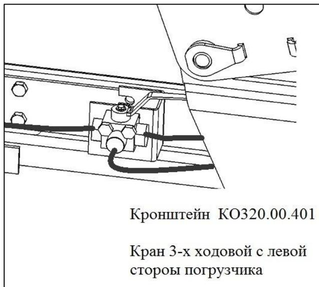
Рис.1 Установка кронштейна и крана
